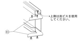
次にテンションコーナー用パイプ(T3)を取付け、テンション本体に補強パイプ(T2)を差し込んで ビス止めし その後テンション用サポータ(K2)で補強をします。
